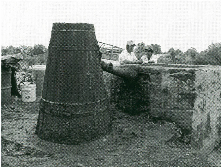
Alambique de madera en La Constancia, Durango
