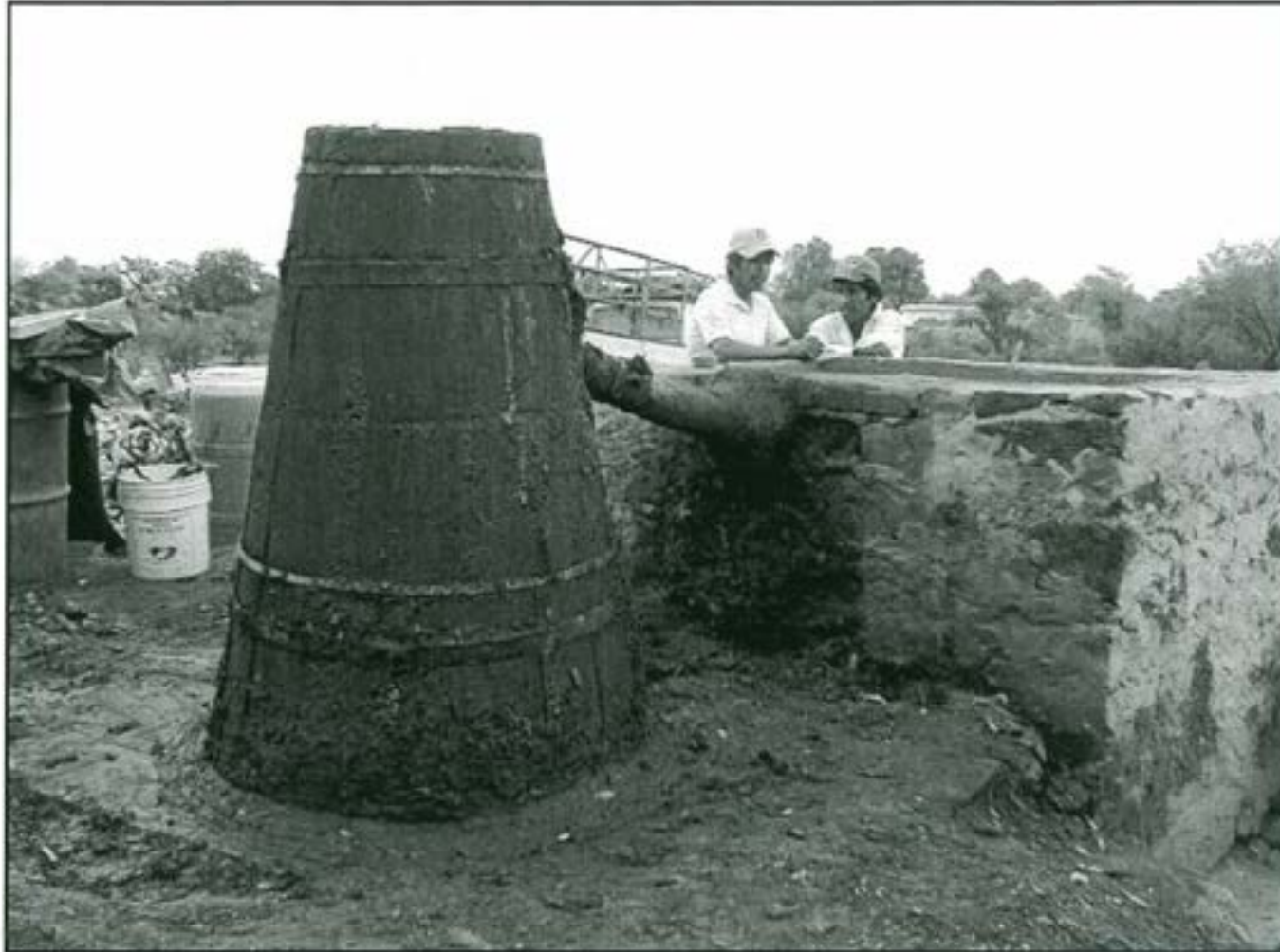
Alambique de madera en La Constanancia, Durango
